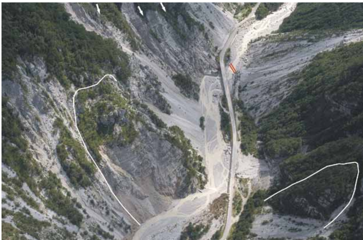
Fig. 30. Ripresa aerea (2 settembre 2003) della stretta di Chiaranda che evidenzia la sua elevata criticità ambientale. Il versante in sinistra Aupa è il tratto più esterno e mobile della DGPV del M. Masarèit, anche a causa dell'erosione al piede delle dissestate dolomie in occasione delle maggiori piene: le frecce bianche indicano alcune delle superfici concave su cui porzioni di dolomie del Membro del Monticello scivolano, ruotando, verso l'alveo del torrente. È scontornata in bianco una piccola frana rotazionale sul versante destro. L'alto grado di suddivisione e di fratturazione delle dolomie produce l'enorme quantità di detriti dei conoidi, in parte mobilizzati da minori colate detritiche. È evidenziata la posizione del vecchio ponte, la cui spalla destra è posizionata al centro del grande conoide (foto gentilmente concessa dalla Protezione Civile della Regione).
